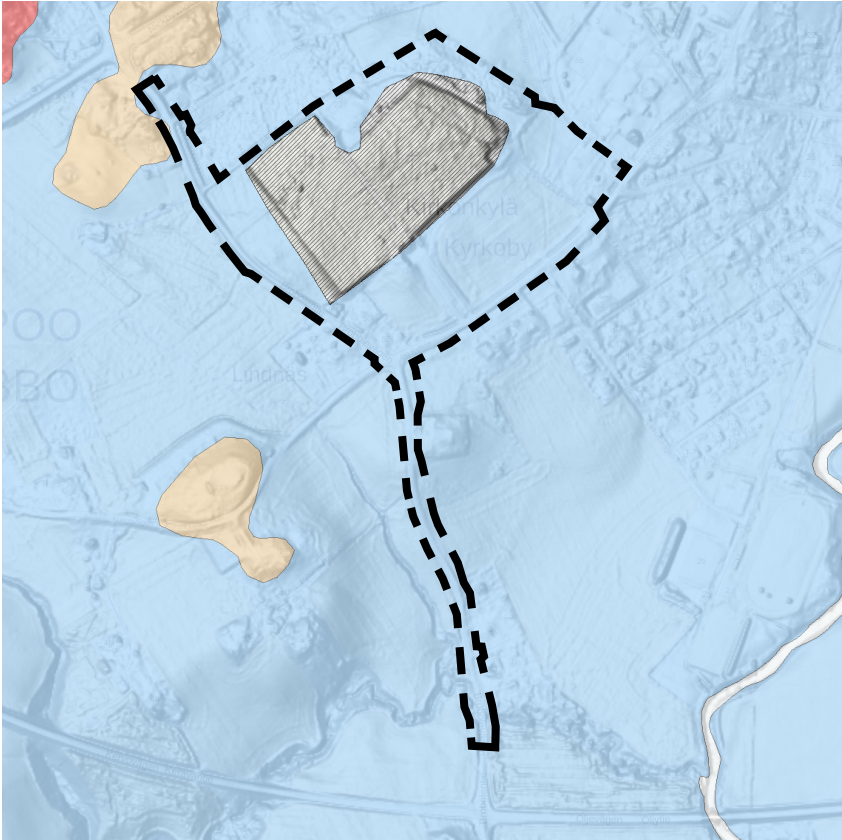
Alueen topografia ja maaperä. Värät: sininen = savi. Viivoitus = täytemaa. Kaavamuutosalueen likimääräinen raja on esitetty mustalla katkoviivalla. (Kuvälähde: GTK, Maankamara) Områdets topografi och jordmån. Färger: blå = lera. Streck = fylljord. Planändringsområdets ungefärliga gräns visas med svart streckad linje. (Bildkälla: GTK, Maankamara)
