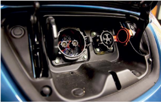
Kuva 12. Kuva erään auton latauspistokkeista. Vasemmalla Chademo-pistoke tasasähkö (DC)-latausta varten ja oikealla Type 1-latauspistoke vaihtosähkö (AC)-latausta varten.
