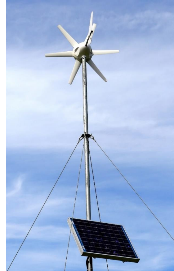
Maston päässä oleva pientuulivoimala yhdessä aurinkopaneelin kanssa. https://pixabay.com/photos/air-battery-blade-breeze-charge-1238449/
