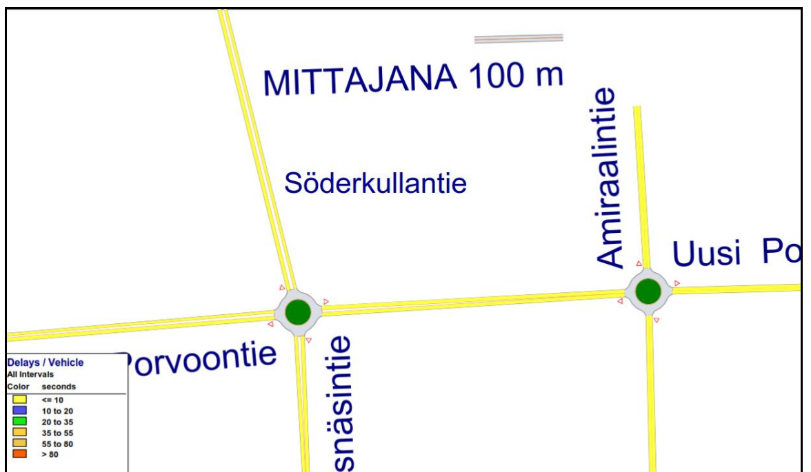
Kuva 15. Keskimääräiset ajoneuvoviivytykset Söderkullantien ja Amiraalintien kiertoliittymässä Uudella Porvoontielle 1,5-kertaisella huipputuntiliikenteellä (iltahuippu).
