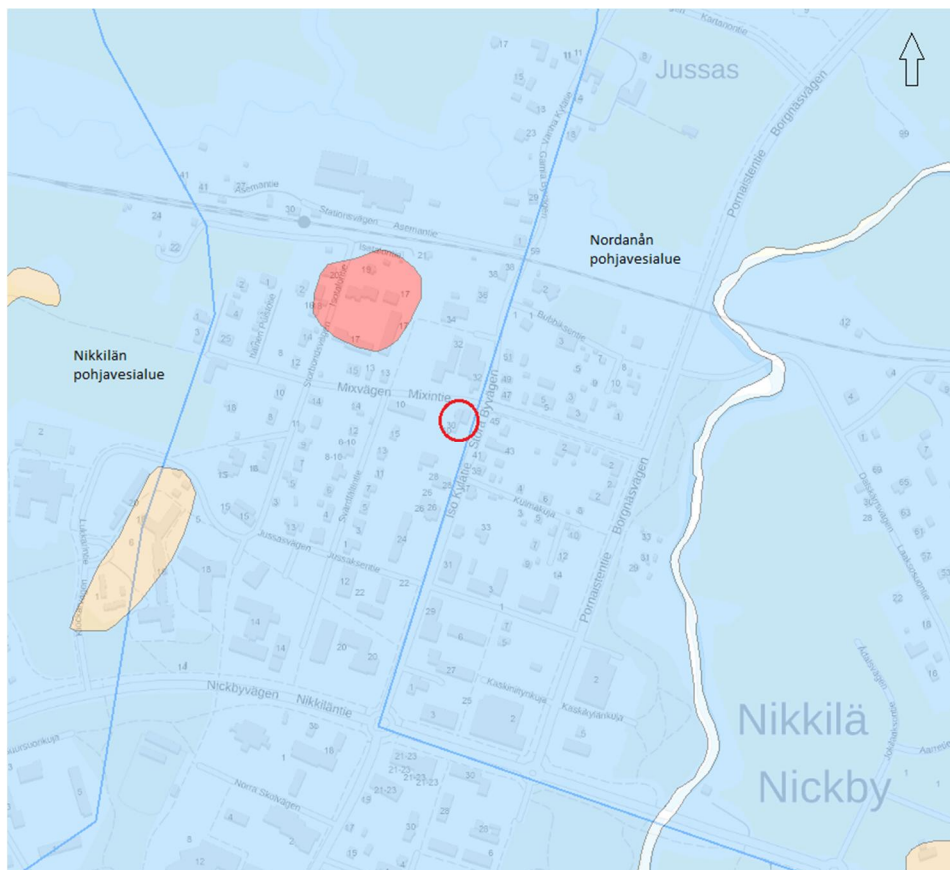
Kuva 1. Alueen maaperäkartta. Tutkimusalueen sijainti on esitetty punaisella rajauksella. Sininen väri edustaa savea ja siniset viivat pohjavesialueiden rajausta itään ja länteen. (GTK:n karttapalvelu) 1
